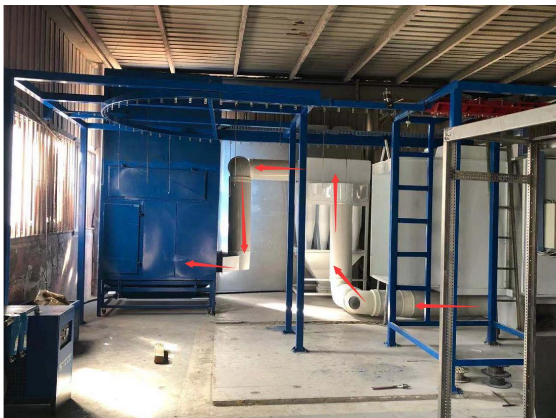
图 4-2 小旋风二级回收系统设备图
